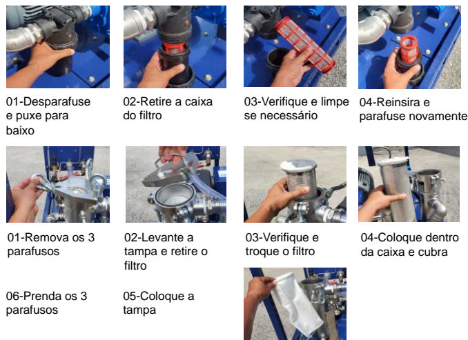
Figura 6.1 - Filtro de inspeção / limpeza de água
