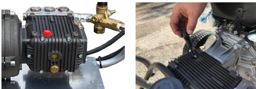
Figura 2 - Nível de óleo da bomba
