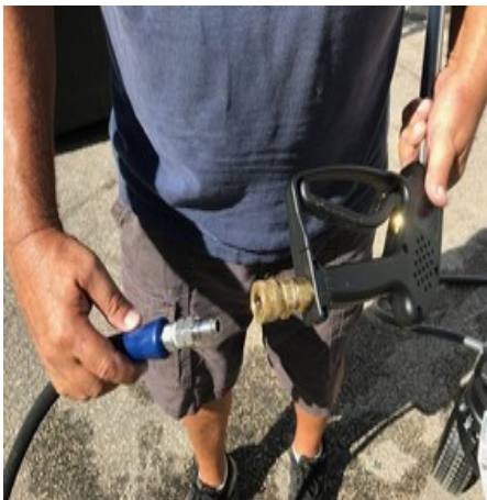
Figura 7 - Conectando a pistola à mangueira de alta pressão
