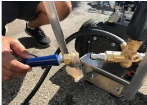
Figura 6 - Conecte a mangueira HP ao regulador de pressão sob conexão rápida
