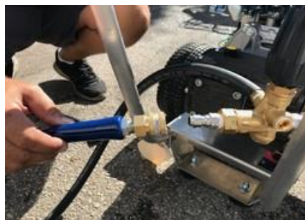
Conecte a mangueira HP à conexão rápida sob o regulador de pressão - Figura # 11
