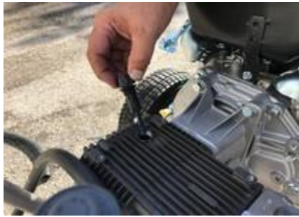
Nível de óleo da bomba - Figura # 3
